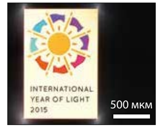
Изменение двулучепреломления в кварцевом стекле. Фото в поляризованном свете
