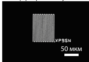
Удаление слоя золота без повреждения подложки из MgO, удаление слоя Au без повреждения
