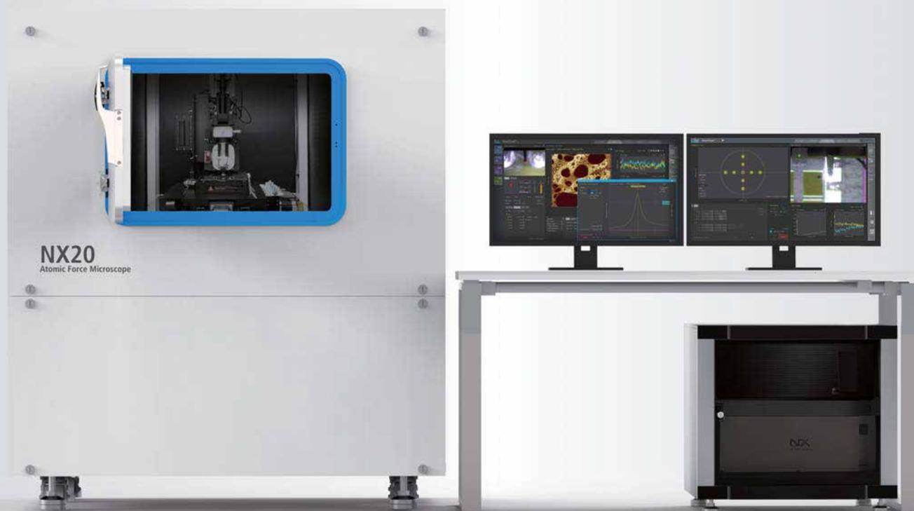
Исследовательский микроскоп промышленного класса для анализа подложек до 300 мм
