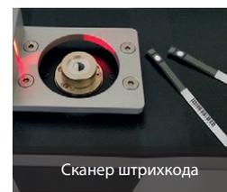
1. Вставьте аланиновый дозиметр. Далее проведите автоматическое считывание штрихкода или введите имя образца вручную.
