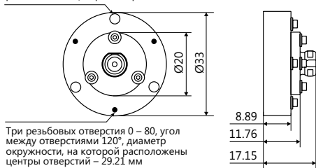
Габаритные размеры крепежного фланца лазеров FFS10/100CHI
