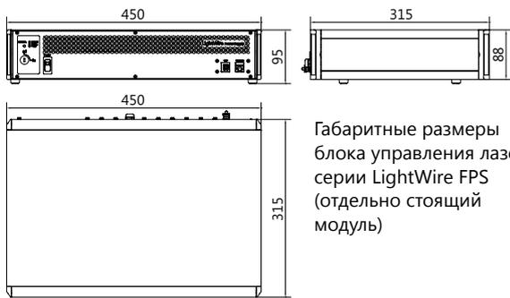
Габаритные размеры блока управления лазеров серии LightWire FPS (отдельно стоящий модуль)
