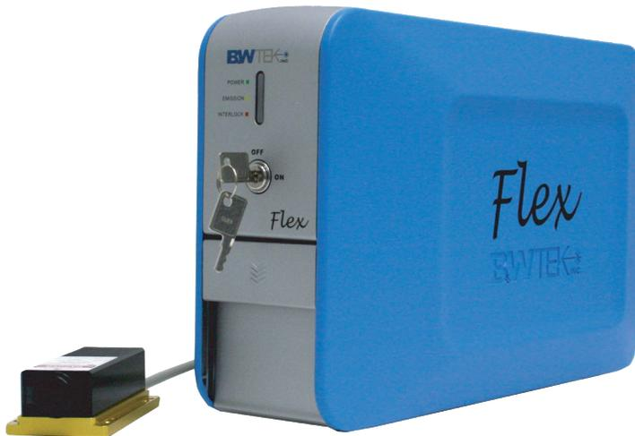
Лазерная система Flex является первым решением компании BWTEK, появившимся в едином корпусе. Больше не мешают никакие провода, панели управления, источники питания или лазерные головки, занимающие место на рабочем столе. Внутреннее термоэлектрическое охлаждение увеличивает надежность работы в диапазоне температур 10 – 35°C, а питание осуществляется за счет подачи на вход переменного тока 100 – 240 В, а энергопотребление составляет менее 40 Вт.
