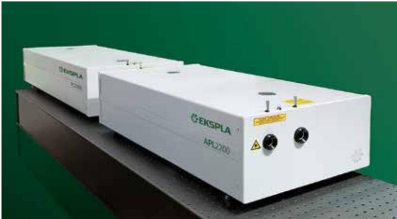
Усилители серии APL2200 разработаны для того, чтобы генерировать пикосекундные импульсы с энергией до 150 мДж при килогерцовых частотах повторения.
