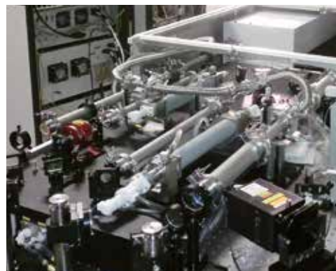
Лазерная система: 12 Дж на 527 нм во время разработки
