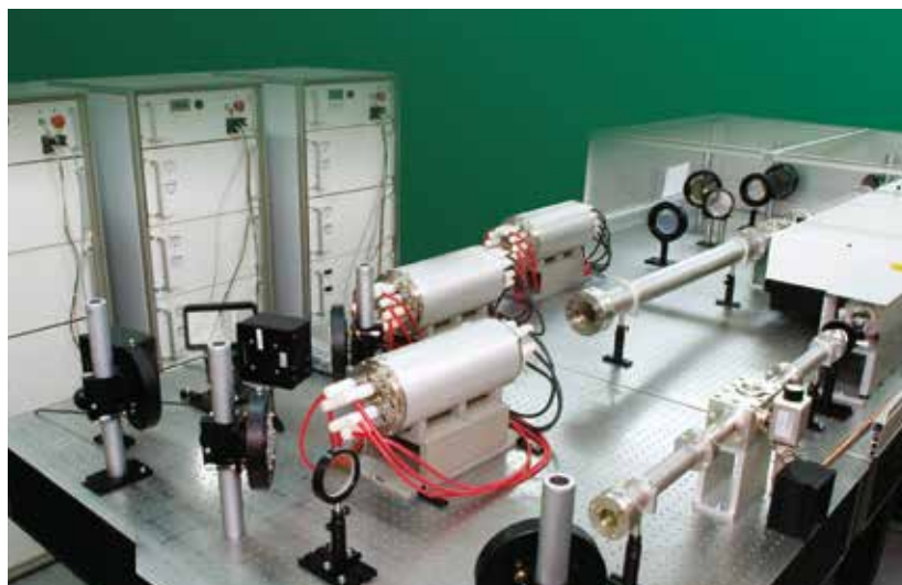
ММ лазерная система: 160 Дж на 1053 нм
