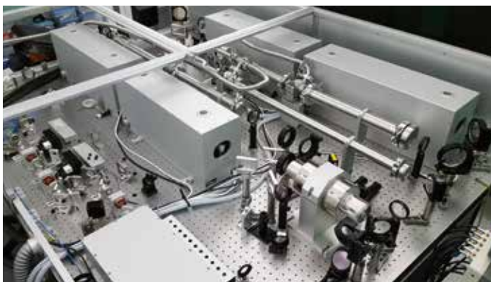
Система на Nd:Glass с энергией 30 Дж, отличающаяся произвольно формируемой временной формой импульса
