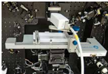
Ванна Ленгмюра для SFG спектрометра: используется для изучения уникальных свойств молекул в монослоях.
