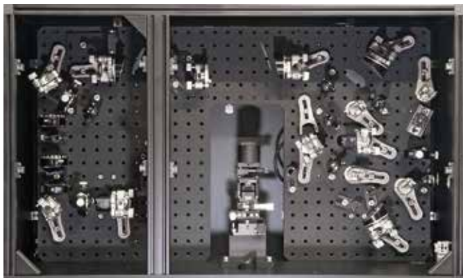
Спектроскопический модуль модели Phase-sensitive SFG: вид внутри (слева), 3D модель (справа).
