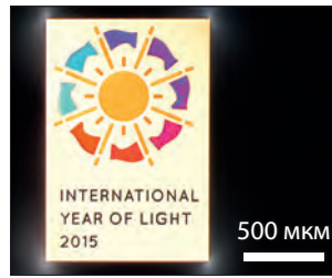
Изменение двулучепреломления в кварцевом стекле. Фото в поляризованном свете
