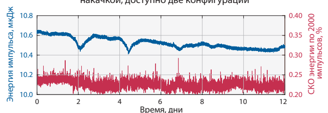
Энергия импульса и стабильность энергии импульсов с пассивной СЕР стабилизацией, генерируемых с помощью ОРСРА с внешней накачкой, измеренные на протяжении 12 дней
