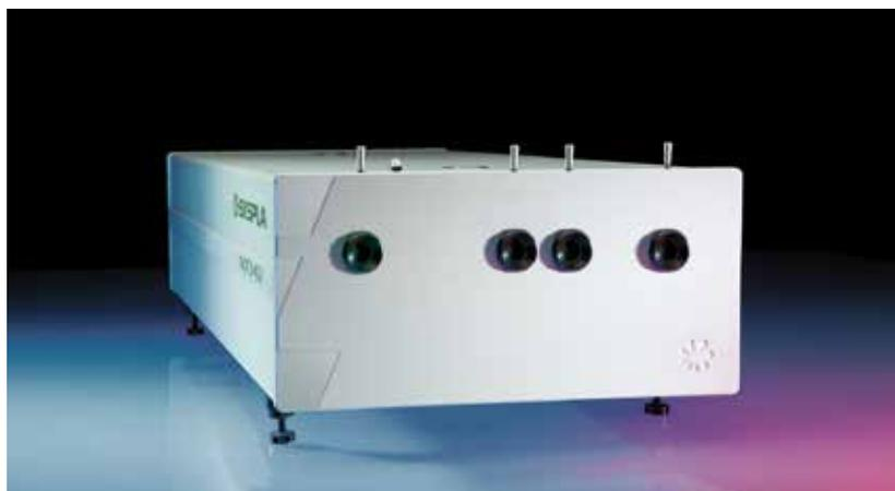
Перестраиваемые наносекундные лазерные системы серии NT342 объединяют в одном корпусе оптический параметрический генератор и Nd:YAG лазер накачки с модуляцией добротности.
