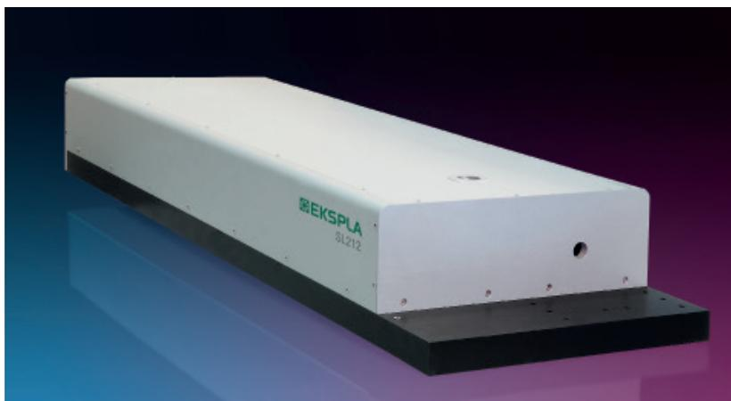
Новый SL212 лазер представляет собой превосходное решение для тех областей, в которых требуются импульсы пикосекундной длительности и высокой энергии. В отличие от обычных лазеров с синхронизацией мод, лазеры данной серии используют другой метод генерации коротких импульсов, основанный на технологии вынужденного рассеяния Бриллюэна (SBS-сжатие).
