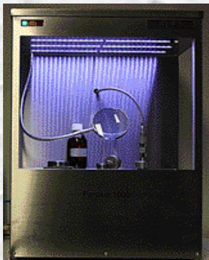
Газо-жидкостной порометр POROLUX™ 1000 с расширенными исследовательскими возможностями, предназначен для проведения быстрых измерений сквозных пор в таких пористых материалах, как мембранны, фильтры, бумага, текстиль, нетканые материалы, пористые волокна и пр.
