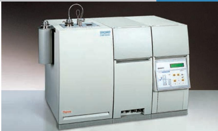
Наиболее распространенные методы исследования катализаторов — термопрограммируемая десорбция, окисление, восстановление, импульсная хемосорбция — теперь легко могут быть проведены в автоматическом режиме с помощью Thermo Scientific TPDRO 1100. Детектор типа TCD делает прибор крайне чувствительным. Thermo Scientific TPDRO может автоматически выполнять пробоподготовку одновременно с анализом благодаря двум независимым печам.
