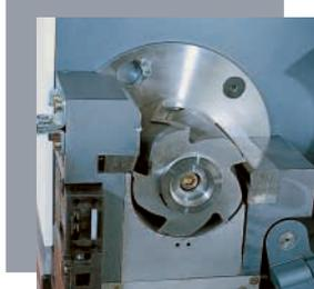
комплект режущих инструментов с ситовой кассетой
