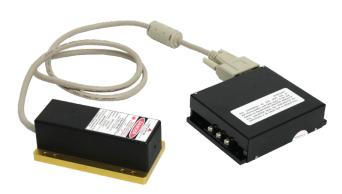
Лазер модели BWN представляет собой твердотельный лазер с диодной накачкой с электрическим управлением. Компактные лазеры модели BWN излучают дифракционно ограниченную моду TEM<sub>00</sub> с качеством пучка M<sup>2</sup>=1.05. Доступно излучение на длине волны 532 нм с переменными параметрами питания. Благодаря этому данная модель идеально подходит для особо требовательных приложений, таких как метрология, фотолюминесценция, печать, освещение, сканирование, инспекция, подсчет
