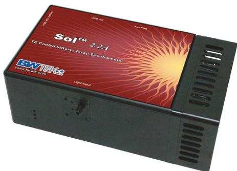
Спектрометр ближнего ИК диапазона Sol™ 2.2A является высокопроизводительным линейным спектрометром с InGaAs детектором с рабочим спектральным диапазоном 900 – 2200 нм. Детектор, состоящий из 256 пикселей и обладающий TE охлаждением до -15 °С с помощью встроенного 3-х ступенчатого кулера, обеспечивает высокую пропускную способность и большой динамический диапазон.
