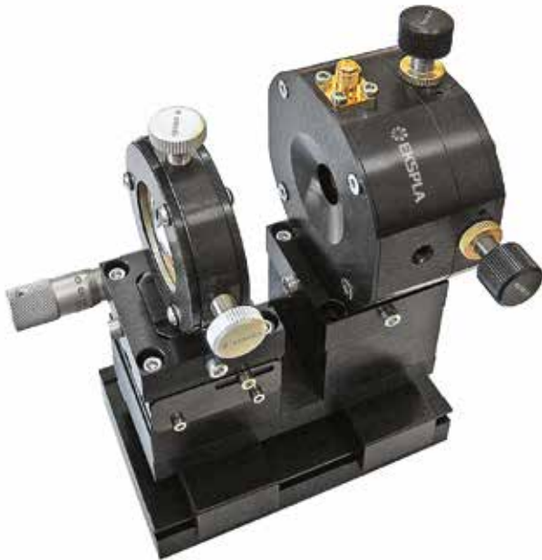
Излучатель (или детектор), закрепленный на держателе
