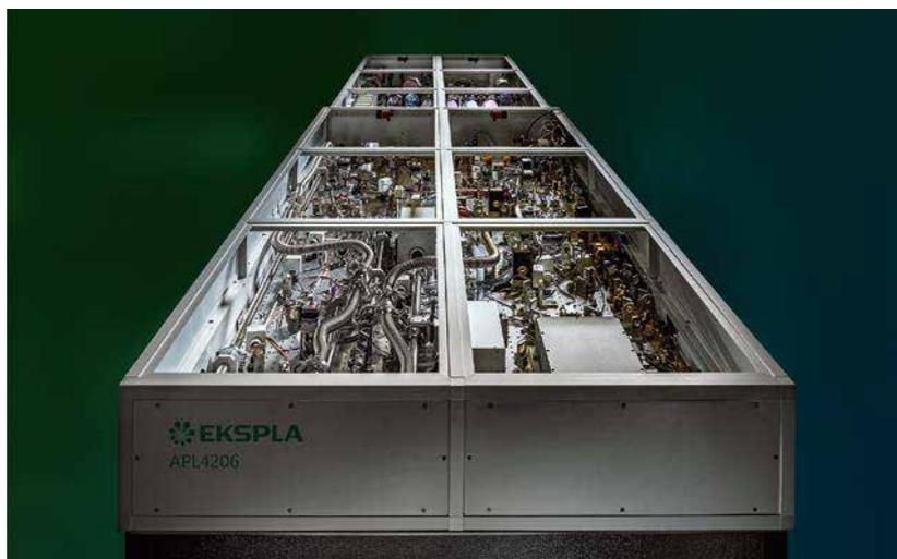
Пикосекундные усилители серии APL4000 разработаны для накачки многокаскадных ОРСПА систем. Они могут разрабатываться в соответствии с требованиями к накачке и иметь до восьми каналов с различными длинами волн, энергией, длительностью импульса, пространственным и временным профилями пучка, регулируемой задержкой.
