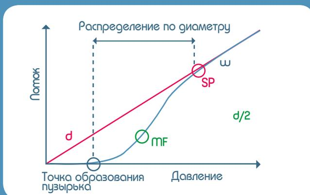
Измеряемые кривые и параметры, полученные в результате применения метода капиллярной порометрии (d = сухая кривая, w = мокрая кривая, d/2 = полусухая кривая, FBP = самая большая пора, MFP = пора среднего потока, SP = самая маленькая пора)
