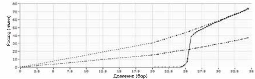
Различные виды мембран могут быть с легкостью измерены, начиная от материалов с очень узким диапазоном пор и заканчивая структурами с широким распределением пор по размерам.
