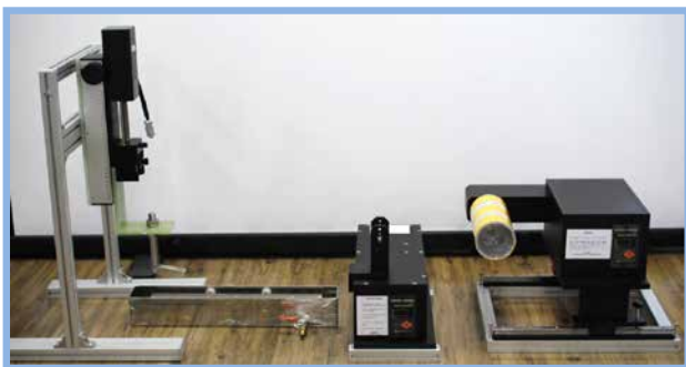
Установка мокрого формования (модель: WS100)
