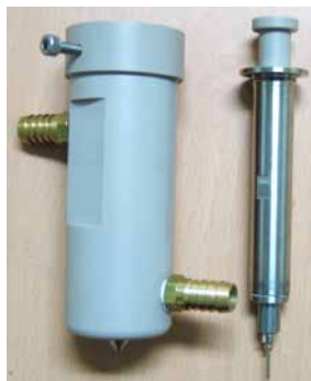
Сопло с нагревом для Электроспиннинга • при повышенных температурах: (циркуляция масла)
