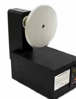
Дисковый коллектор (для выравнивания) Модель: NNC-AC180
