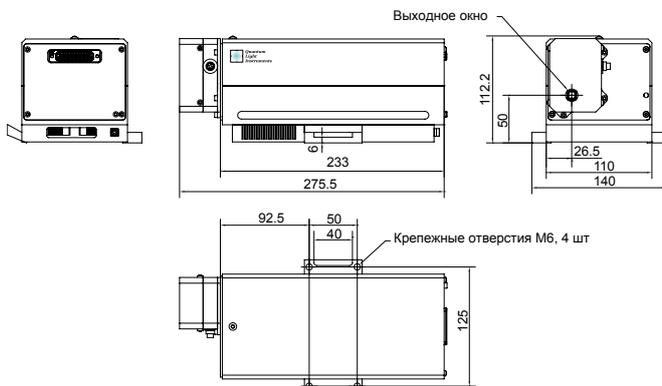
Габаритные размеры лазерной головки Q1 вместе с моторизированным аттенюатором (мм)
