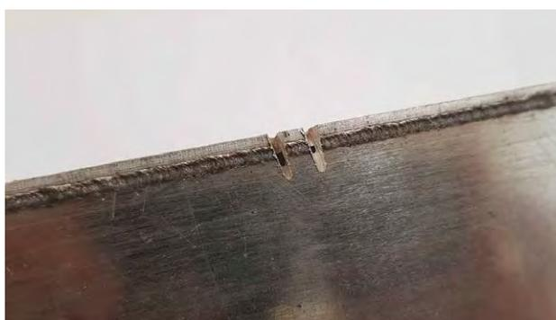
*Вырез сварного шва лазерной сварки в алюминии*
