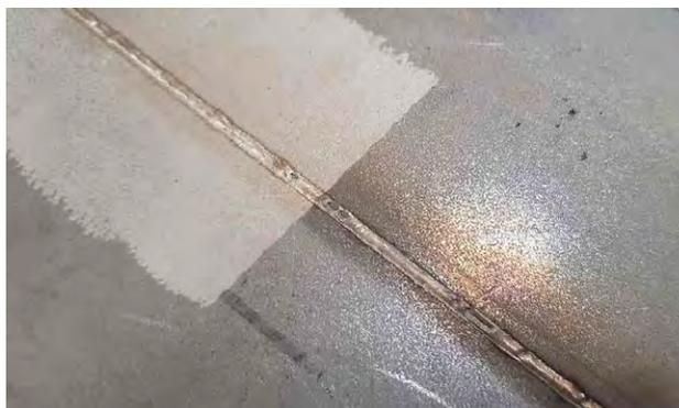
*Обработка сварного шва лазерной очисткой*
