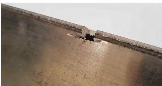
*Вырез сварного шва лазерной сварки*
