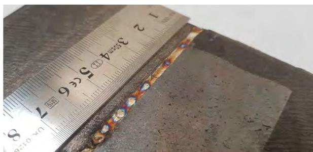
*Оксидация черного металла после лазерной сварки*
