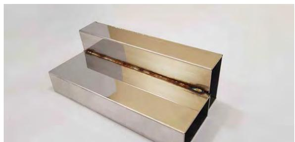
Соединение нержавеющей стали с низким тепловым эффектом на материал
