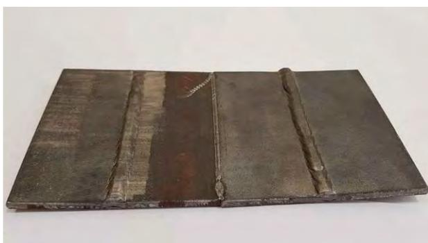
*Сварка волоконным лазером против традиционной сварки на черном металле*
