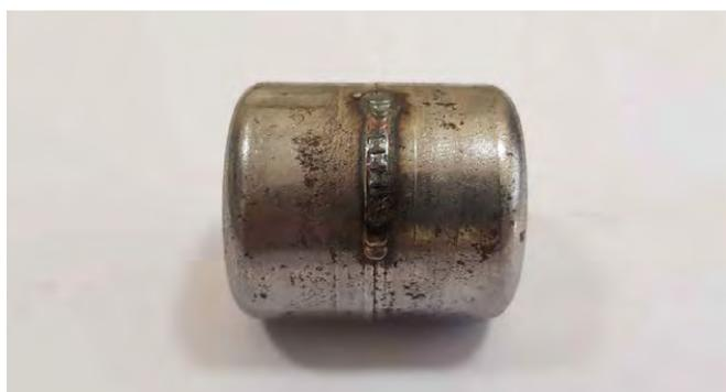
*Урон от оксидации после использования 2 кВт систем лазерной сварки*
