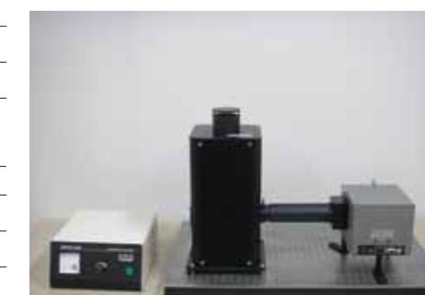
Монохроматор MonoRa150i с 450 Вт ксеноновой лампой модели DL450-XE
