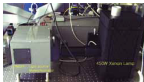
Монохроматор MonoRa200 с 450 Вт ксеноновой лампой модели DL450-XE
