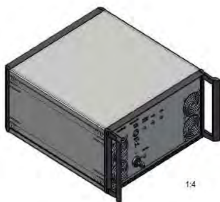
Отдельно-стоящий блок управления Длина: 375 мм; Ширина: 356 мм; Высота: 184 мм (все размеры в мм)
