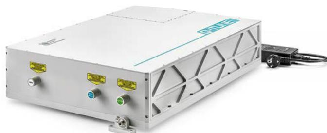
Q-TUNE представляет собой лазер с перестраиваемой длиной волны, компоненты которого заключены в едином монолитном корпусе. Перестройка по длине волны осуществляется в диапазоне 410 – 2300 нм за счет оптического параметрического генератора (ОРО/ОПГ), а спектральная ширина линии меньше 6 см<sup>-1</sup>. Также доступна опция генерации второй гармоники для расширения диапазона перестройки до 210 – 410 нм со спектральной шириной линии < 12 см<sup>-1</sup>.
