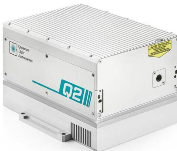
Q2 – это компактный лазер с диодной накачкой, полностью с воздушным охлаждением и с модуляцией добротности, разработанный для широкого круга задач, требующих импульсов высокой пиковой мощности.
