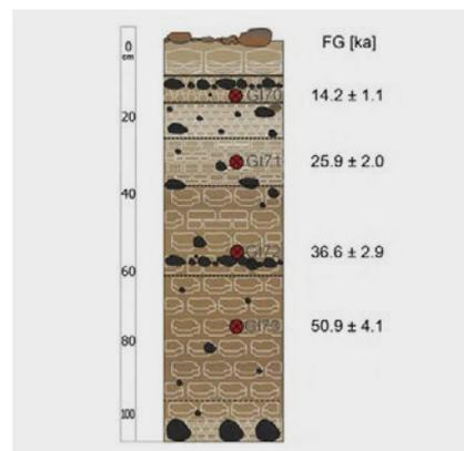
Профиль осадочных отложений с отмеченными точками забора пробы и результаты OSL датирования единичных зерен кварца
