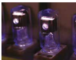
Спектральное распределение (дейтериевая лампа 30 Вт для УФ диапазона)
