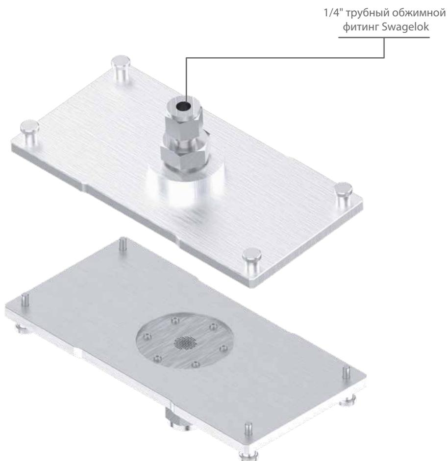
В исследованиях с газовым датчиком, крышка с распылительной насадкой может применяться для проверки быстрого времени отклика путем прямой подачи газа на газовый датчик.
