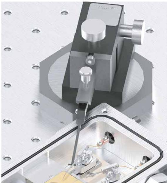
Точный зондовый сканатор - это аксессуар для точной и тонкой регулировки с помощью внешнего микро-позиционера, когда размер контактной площадки мал. Стабильный контакт возможен на контактной площадке 200 мкм при использовании опции внешнего положения. Для контактных площадок размером менее 200 мкм рекомендуется использовать пьезопозиционер.
