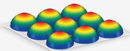
Для получения 3D-профиля поверхности образца, оптически-секционные плоские изображения собираются вдоль оси Z. Поскольку интенсивность света становится максимальной, когда поверхность образца помещается в фокальную плоскость, можно напрямую определить осевые координаты поверхности образца. С помощью фиолетового лазера, фотоумножителя (ФЭУ) и пьезоэлектрического осевого сканера NS-3800 выполняется конфокальное оптическое сечение наиболее надежным способом.
