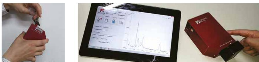
Работа от аккумулятора и беспроводного интерфейса расширяет возможности применения в полевых условиях
