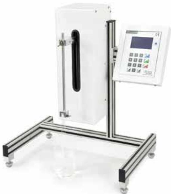
Система NXTdip-150S использует золь-гель метод погружения субстрата в камеру с материалом покрытия при контролируемых параметрах для создания тонкой пленки материала покрытия на субстрате. Благодаря наличию дополнительных опций можно провести апгрейд данного универсального инструмента в любое время, чтобы получить максимально качественные результаты.
