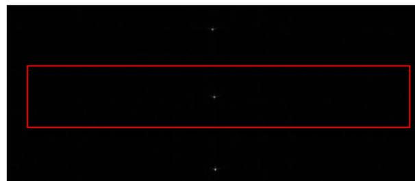
Рис. 7. Типичный вид сигнала с КМОП-сенсора, когда спектрометр HyperFine освещен широкополосным светом (вверху) и монохроматическим лазером с узкой шириной линии (внизу). Полный спектр можно извлечь, «развернув» информацию в областях, отмеченных рамкой.
