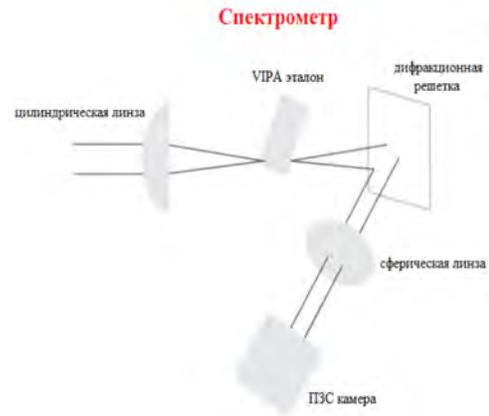
Рис. 5. Схема расположения оптических компонентов спектрометра HyperFine [9]. VIPA рассеивает падающий свет в вертикальном направлении, обеспечивая высокое разрешение, но также и перекрывающиеся порядки. Дифракционная решетка разделяет перекрывающиеся порядки по горизонтали.
