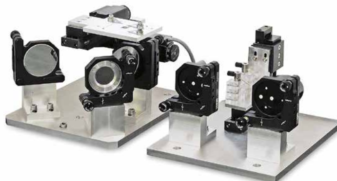
Измерительные модули T-SPEC: геометрия на отражение (слева) и геометрия на пропускание (справа)
