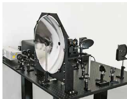
Оптическая схема ТГц спектроскопического набора в конфигурации на пропускание
