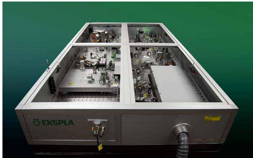
Рис. 4. *Пример поставленной кастомизированной системы UltraFlux FT310: - компактная (1.2 × 0.9 м) фс перестраиваемая лазерная система с полностью диодной накачкой с энергией в импульсе до 2.5 мДж и длительностью импульса порядка 20 фс. Оптически синхронизированные (низкий джиттер) фс и пс выходы также доступны.
