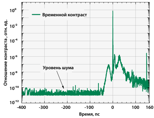
Рис. 3. Типовой временной контраст лазерных систем серии UltraFlux.
