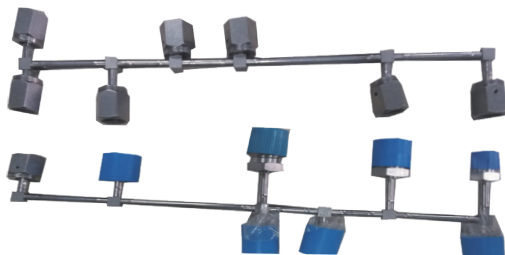
Коллекторы из стали 316L с микросваркой
