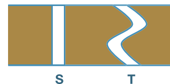
Рис. 2: пример двух пор с одинаковым диаметром, но с различной длиной поры, следовательно, извилистостью.
